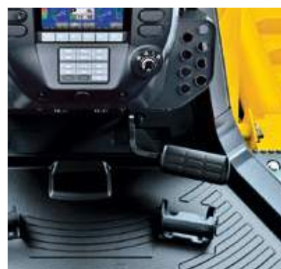
Le pilotage de la machine est facilité grâce à l'installation d'une seule pédale associant la commande de freinage et la pédale de décélération. La vitesse de déplacement est contrôlée à l'aide d'une seule pédale. La fonction de la pédale peut être modifiée à l'aide d'un sélecteur de mode.
