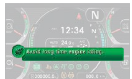
Les conseils éco prennent en charge les économies d'énergie en temps réel (p.ex. éviter les phases au ralenti prolongées)
