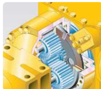
Freins multi-disques à bain d'huile
