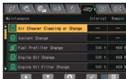
Un écran multifonctions affiche et contrôle de nombreuses informations d'utilisation et d'entretien
