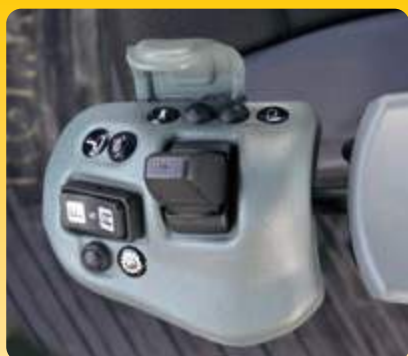
Levier court de direction Komatsu (K-SLS) (option)
