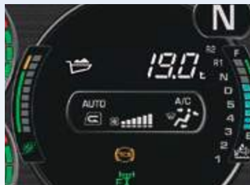
Le compteur de charge utile affiche le poids de la charge
