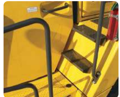
Accès sûr à la cabine à l'aide de main courante, loin des risques potentiels de l'articulation
