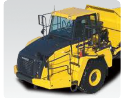
ROPS/FOPS intégrés conformes aux normes ISO 3471 et SAE J1040-1988c
