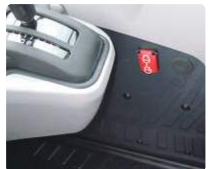
Interrupteur d'arrêt secondaire du moteur
