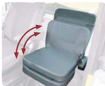
L'instructeur dispose d'un siège à part entière, équipé d'un coussin et d'un dossier escamotables pour dégager l'accès à la cabine, ainsi qu'au filtre de la climatisation et à la boîte à gants.
